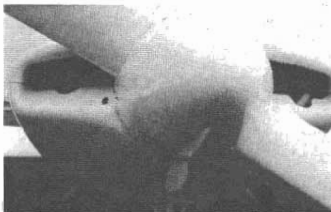
Vorbildlich ausgeführter Lufteinlaß an einer Cherry
